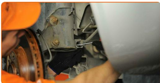
**10** Débranchez le câblage du capteur ABS. Débranchez la fixation du fil du capteur d'usure de plaquette de frein de la jambe de suspension. Utilisez un tournevis plat.
