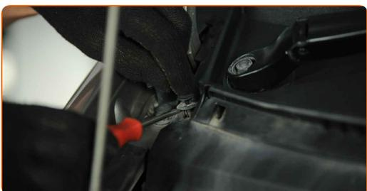
**20** Dévissez les fixations des bras d'essuie-glaces. Utilisez une douille n° 13. Utilisez une clé à cliquet.
