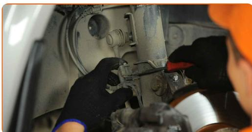
**11** Nettoyez les fixations assurant la connexion entre la jambe d'amortisseur et le porte-fusée. Utilisez une brosse métallique. Servez vous de l'aérosol WD-40.
