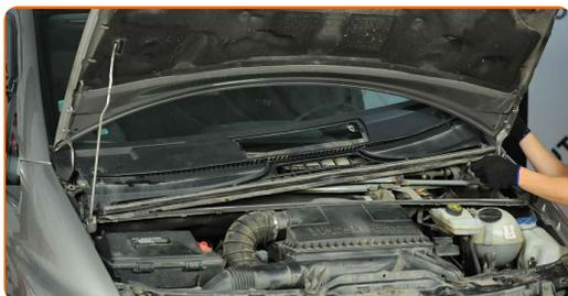
**27** Dévissez les fixations du panneau de la tringlerie de l'essuie-glace. Utilisez une douille n° 13. Utilisez une clé à cliquet.
