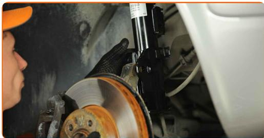
**70** Installez les boulons de fixation.
