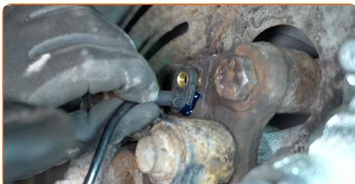
Remplacement : capteurs ABS – Opel Vivaro A van. Les professionnels recommandent :
