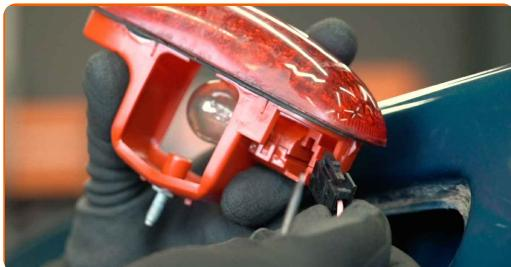
Remplacement : feu stop additionnel – Opel Vivaro A van. Les experts d'AUTODOC recommandent :
