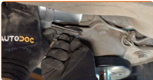
**16** Vissez le boulons de fixation du support du filtre à carburant. Utilisez une douille n° 12. Utilisez une clé à cliquet.
