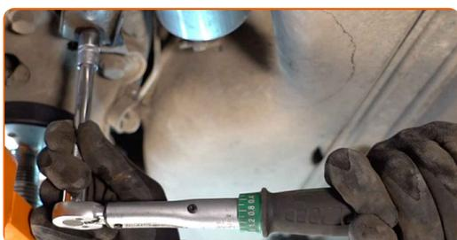
**19** Vissez le bouchon sur le régulateur de la pression.
