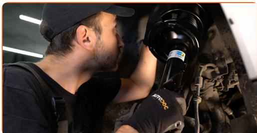
**45** Vissez l'attache supérieure du support de l'amortisseur. Ne serrez pas trop.
