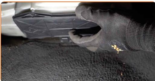
**9** Vissez les attaches du couvercle du boîtier du filtre d'habitacle. Utilisez la mèche Torx T20. Utilisez une clé à cliquet.
