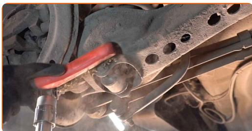
**14** Dévissez l'attache inférieure de l'amortisseur. Utilisez une douille n° 18. Utilisez un porte-taraud.
