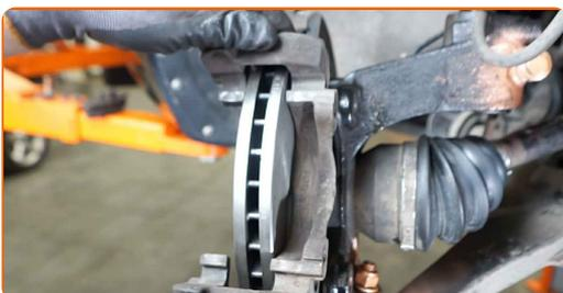
**29** Installez les boulons de fixation.
