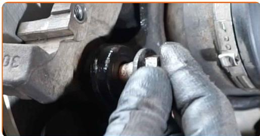
**30** Serrez les fixations du support d'étrier de frein. Utilisez une douille n° 18. Utilisez une clé dynamométrique. Serrez-le jusqu'à 150 Nm.
