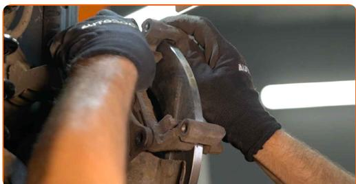
**20** Serrez le support de l'étrier de frein. Utilisez une douille n° 13. Utilisez une clé dynamométrique. Serrez-le jusqu'à 70 Nm.
