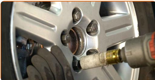
**32** Abaissez la voiture et serrez les boulons de roue en ordre croisé. Utilisez une clé dynamométrique. Serrez-le jusqu'à 110 Nm.
