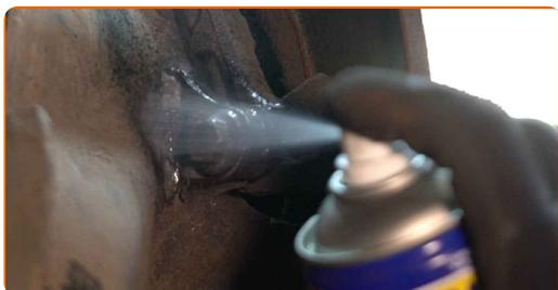
**13** Dévissez l'attache du support d'étrier. Utilisez une douille n° 13. Utilisez une clé à cliquet. Utilisez un porte-taraud.
