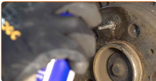
**17** Dévissez l'attache du disque de frein. Utilisez une douille n° 10. Utilisez une clé à cliquet.
