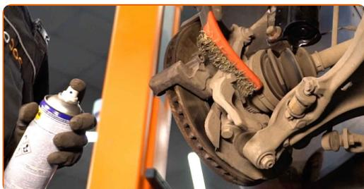
**14** Dévissez l'attache du support d'étrier. Utilisez une douille n° 15. Utilisez un porte-taraud. Utilisez une clé à cliquet.
