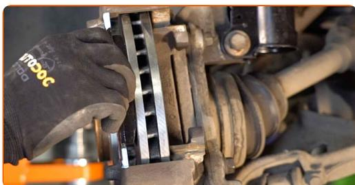
Remplacement : plaquettes de frein – VOLVO V70 I (875, 876). Les professionnels recommandent :
