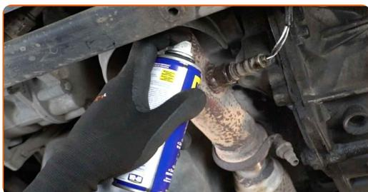
**5** Dévissez la fixation de la sonde lambda. Utilisez une douille à sonde lambda de 22 mm. Utilisez une clé à cliquet.
