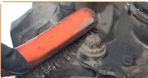
**12** Dévissez les fixations du support d'étrier de frein. Utilisez une douille n° 18. Utilisez une clé à cliquet.
