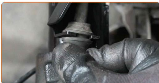
**80** Serrez les fixations inférieures de la jambe de suspension. Utilisez une douille n° 15. Utilisez une clé dynamométrique. Serrez-le jusqu'à 110 Nm.
