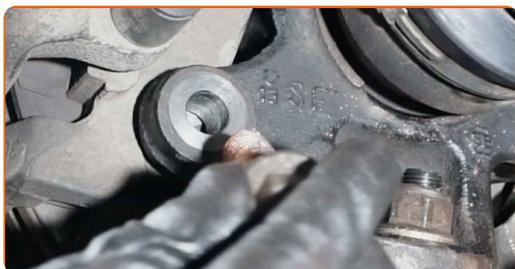
**78** Vissez les fixations du support d'étrier de frein. Utilisez une douille n° 18. Utilisez une clé à cliquet.
