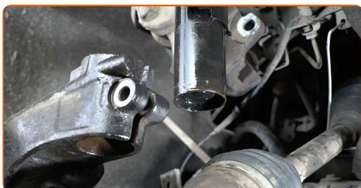
**43** Retirez la fusée d'essieu avec le moyeu de roue.
