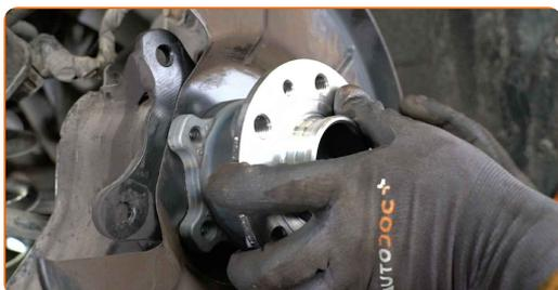
**32** Installez les boulons de fixation.
