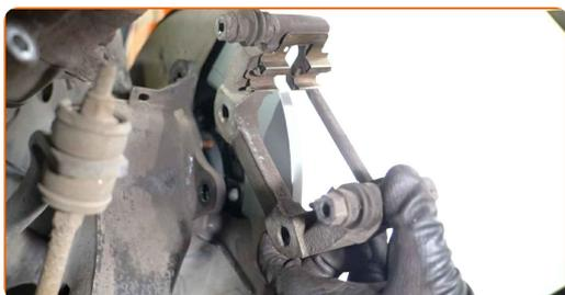
**44** Installez les boulons de fixation.
