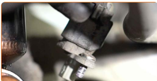
**23** Retirez l'écrou de fixation.
