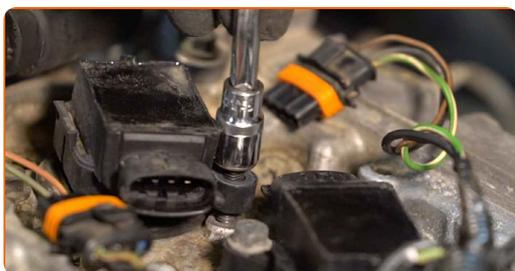
**21** Appliquez du produit sur la bobine d'allumage. Le produit protégera les contacts électriques de la corrosion, de l'oxydation et réduira la résistance des contacts.
