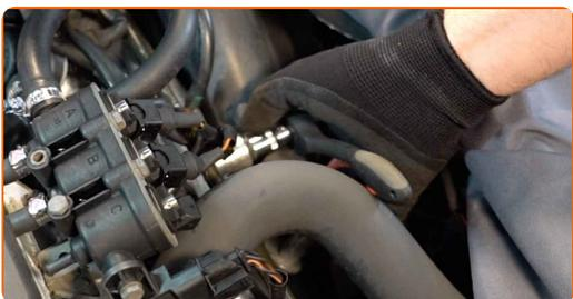
**7** Détachez le collier de serrage de la durite d'admission d'air. Utilisez une douille n° 7. Utilisez une clé à cliquet.
