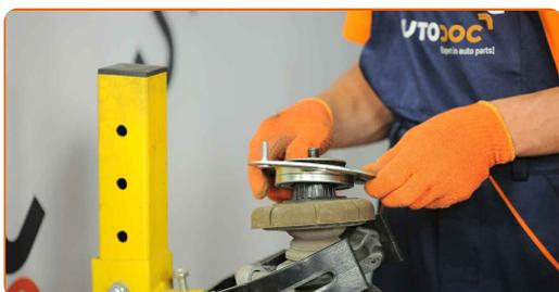
**28** Serrez l'écrou de l'entretoise d'amortisseur due la tige de piston. Utilisez une clé mixte de No.21 Utilisez la mèche Torx T50. Utilisez une clé dynamométrique. Serrez-le jusqu'à 70 Nm.
