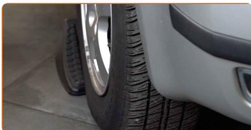
**2** Desserrez les boulons de fixation de la roue. Servez-vous d'une douille à choc pour roue N°19.
