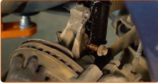
**41** Installez les boulons de fixation.
