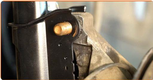
**42** Serrez les fixations inférieures qui relient l'amortisseur à la fusée d'essieu. Utilisez une clé mixte de No.18. Utilisez une douille n° 21. Utilisez une clé dynamométrique. Serrez-le jusqu'à 105 Nm.+75°
