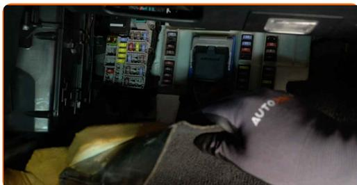
**4** Dévissez les fixations du panneau latéral sous planche de bord du côté passager. Utilisez la mèche Torx T25.
