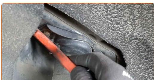
**8** Dévissez les fixations du support de l'amortisseur. Utilisez une douille n° 10. Utilisez une clé à cliquet.
