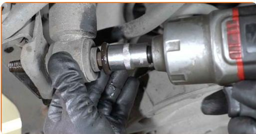
**12** Retirez l'écrou de fixation.
