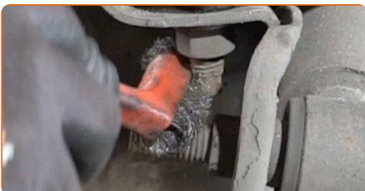
**11** Dévissez les fixations inférieures de l'amortisseur. Utilisez une douille n° 18. Utilisez une clé à cliquet.
