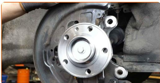
**70** Installez les boulons de fixation.
