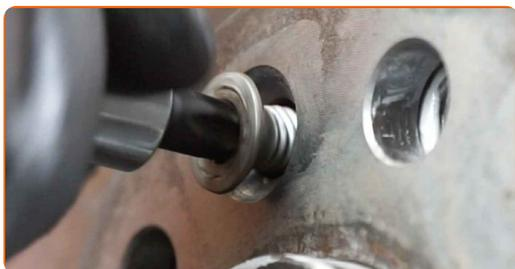
**75** Serrez les fixations du disque de frein. Utilisez la mèche Torx T50. Utilisez une clé dynamométrique. Serrez-le jusqu'à 15 Nm.
