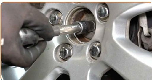
**5** Desserrez les boulons de la roue. Servez-vous d'une douille à choc pour roue N°19. Utilisez un porte-taraud.
