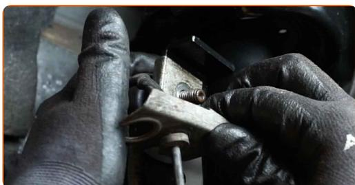
**65** Vissez la fixation qui relie la biellette de barre stabilisatrice à la jambe de suspension. Utilisez une douille n° 15. Utilisez une clé à cliquet.
