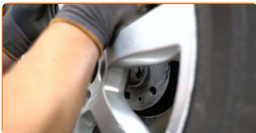
Remplacement : roulement de roue – VOLVO XC70 II Break (136). Conseil :
