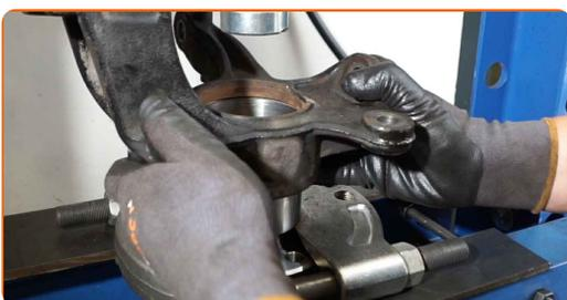
Remplacement : roulement de roue – VOLVO XC70 II Break (136). Les experts d'AUTODOC recommandent :
