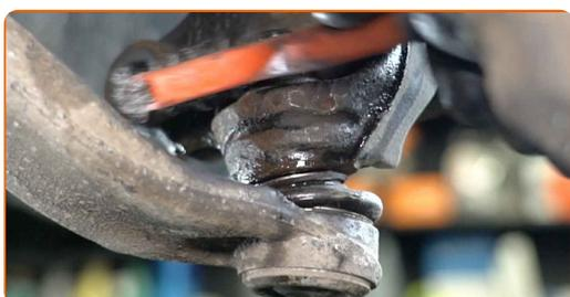
**37** Dévissez la fixation connectant le joint à rotule à la fusée d'essieu. Utilisez une clé mixte de No.21.
