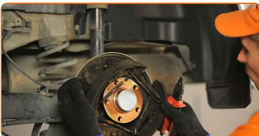
Remplacement : mâchoires de frein – VW Beetle 3/5 portes (5C1, 5C2).
