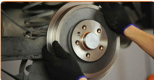
**25** Serrez les fixations des tambours de frein. Utilisez la mèche Torx T30. Utilisez une clé dynamométrique. Serrez-le jusqu'à 4 Nm.
