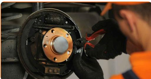
**23** Nettoyez le moyeu. Utilisez une brosse métallique. Traitez la surface de contact. Utilisez de la graisse au cuivre.
