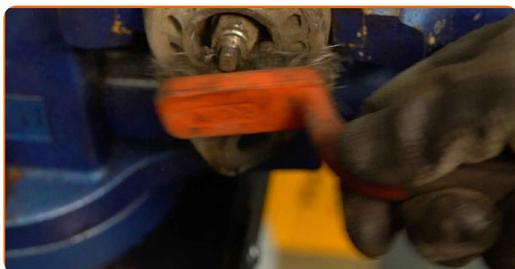
**26** Retirez l'attache de la tige du piston de l'amortisseur. Servez-vous d'un embout d'amortisseur DD n° 5. Utilisez une douille n° 17. Utilisez une clé à cliquet.
