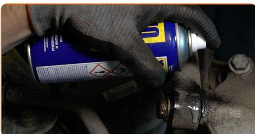
**16** Dévissez les fixations inférieures de l'amortisseur. Utilisez une douille n° 21. Utilisez une clé à cliquet.
