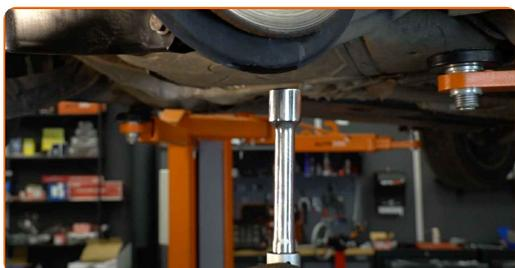
Remplacement : amortisseur – VW Beetle 3/5 portes (5C1, 5C2). Les experts d'AUTODOC recommandent :
