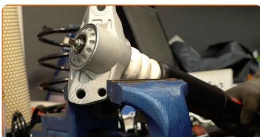
**31** Appliquez du produit sur l'élément de fixation de la tige de l'amortisseur. Utilisez de la graisse au cuivre.
