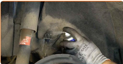
**18** Dévissez les fixations de la garniture de passage de roue. Utilisez la mèche Torx T25. Utilisez une clé à cliquet.
