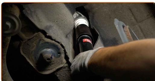
**Remplacement : amortisseur – VW Beetle 3/5 portes (5C1, 5C2). Conseil :**
