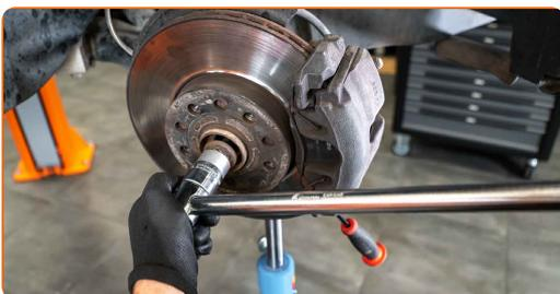
28 Dévissez les fixations qui lient le joint à rotule au bras de contrôle de suspension. Utilisez une douille n° 16.
