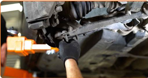
30 Retirez l'arbre d'entraînement du moyeu de roue.
