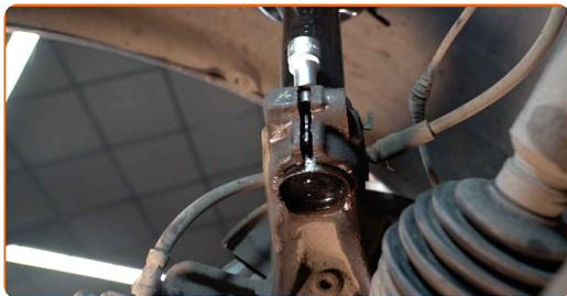
**51** Installez l'écrou de fixation.
