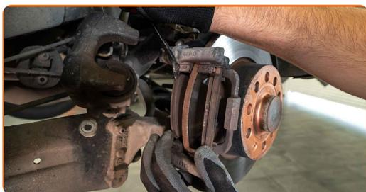
Remplacement : plaquettes de frein – VW Beetle Cabriolet (5C7, 5C8). Les experts d'AUTODOC recommandent :
