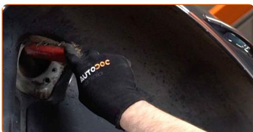
**23** Appliquez du produit sur les emplacements de montage des amortisseurs. Utilisez de la graisse au cuivre.
