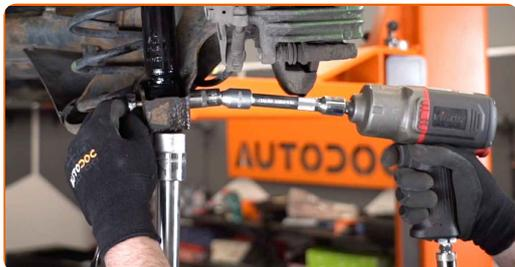
**29** Serrez l'attache de l'amortisseur supérieur. Utilisez une clé mixte de No.16 Utilisez une douille n° 16. Utilisez une clé dynamométrique. Serrez-le jusqu'à 30 Nm.+90°
