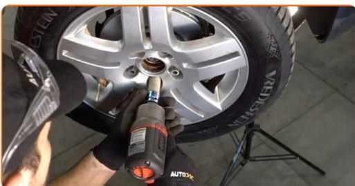
**25** Abaissez la voiture et serrez les boulons de roue en ordre croisé. Utilisez une clé dynamométrique. Serrez-le jusqu'à 120 Nm.
