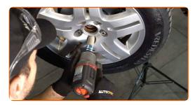
Abaissez la voiture et serrez les boulons de roue en ordre croisé. Utilisez une clé dynamométrique. Serrez-le jusqu'à 120 Nm.
