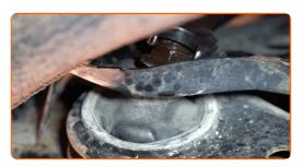
Dévissez l'attache du bras avant. Utilisez une douille n° 18. Utilisez une clé à cliquet.
