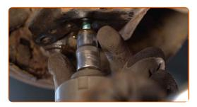
Desserrez la fixation avant du bras de suspension. Utilisez une douille n° 18. Utilisez un porte-taraud.
