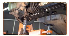
Serrez la fixation avant reliant le bras de commande au sous-châssis. Utilisez une douille n° 18. Utilisez une clé dynamométrique. Serrez-le jusqu'à 70 Nm.+90°
