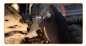
Dévissez les fixations qui lient le joint à rotule au bras de contrôle de suspension. Utilisez une douille n° 13. Utilisez un porte-taraud.
