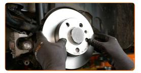
24 Installez l'écrou de fixation.
