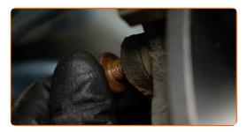
Serrez les fixations du support d'étrier de frein. Utilisez la clé HEX n° H8. Utilisez une clé dynamométrique. Serrez-le jusqu'à 65 Nm.
