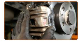
35 Installez les boulons de fixation.
