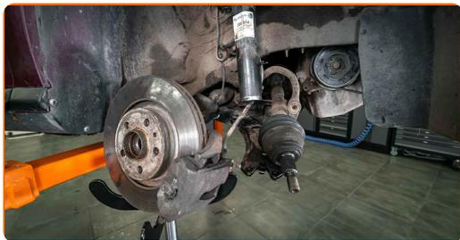
Remplacement : ressort de suspension – VW Bora Variant (1J6). AUTODOC recommande :
