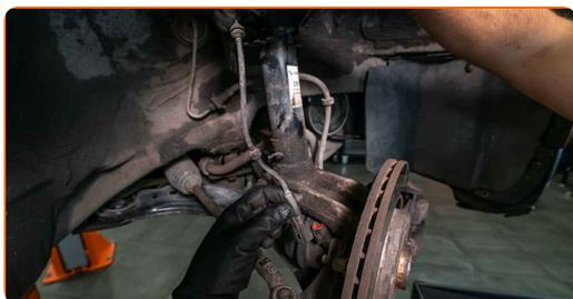
**48** Nettoyez le siège de fixation de la jante. Utilisez une brosse métallique. Traitez la surface de contact. Utilisez de la graisse au cuivre.
