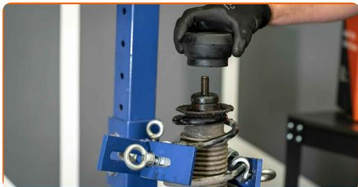
**33** Serrez l'écrou de l'entretoise d'amortisseur due la tige de piston. Servez-vous d'une douille polygonale ouverte n°22. Utilisez la clé HEX n° H6. Utilisez une clé dynamométrique. Serrez-le jusqu'à 60 Nm.
