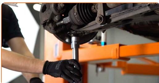
**17** Dévissez la fixation inférieure assurant la connexion entre la jambe d'amortisseur et le porte-fusée. Utilisez une clé mixte de No.18. Utilisez une douille n° 18.
