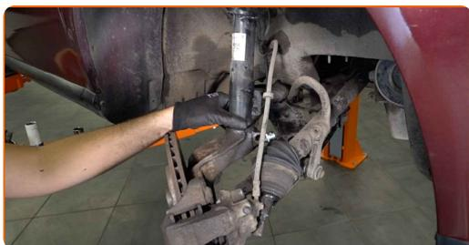
**Remplacement : ressort de suspension – VW Bora Variant (1J6). Les experts d'AUTODOC recommandent :**
