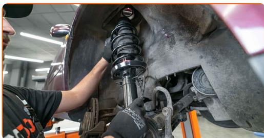
**37** Serrez l'écrou de fixation supérieur de l'entretoise de l'amortisseur. Ne serrez pas trop.
