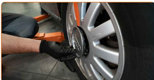
**5** Dévissez l'écrou du moyeu. Servez-vous d'une douille 12 pans de 1-3/16 pouces.
