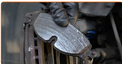
Remplacement : plaquettes de frein – VW CADDY ALLTRACK Variant (SAB).
