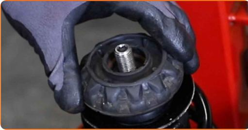
31 Serrez l'écrou de l'entretoise d'amortisseur due la tige de piston. Utilisez la clé HEX n° H7. Utilisez une douille pour écrou de jambe de suspension de 21 mm. Utilisez une clé dynamométrique. Serrez-le jusqu'à 60 Nm.
