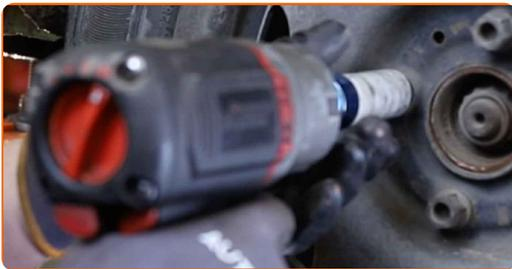
49 Abaissez la voiture et serrez les boulons de roue en ordre croisé. Servez-vous d'une douille à choc pour roue N°17. Utilisez une clé dynamométrique. Serrez-le jusqu'à 110 Nm.
