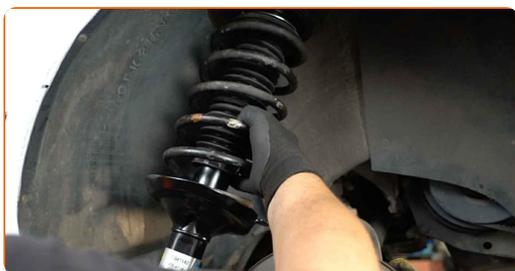
**32** Vissez l'attache supérieure du support de l'amortisseur. Ne serrez pas trop.
