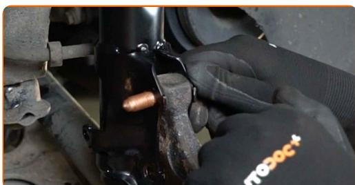
**36** Vissez les fixations reliant la jambe de suspension à la fusée d'essieu. Utilisez une clé mixte de No.18. Utilisez une douille n° 18. Utilisez un porte-taraud.
