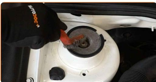
**4** Devissez la fixation supérieure du support d'amortisseur. Utilisez la clé HEX n° H6. Utilisez une douille n° 21. Utilisez une clé à cliquet.
