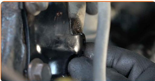
**41** Serrez le collier de serrage du flexible de frein de l'entretoise de l'amortisseur. Utilisez une douille n° 10. Utilisez une clé dynamométrique. Serrez-le jusqu'à 13 Nm.
