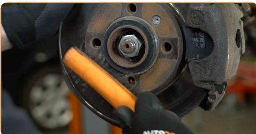
**44** Appliquez du produit sur la zone de contact entre le disque de frein et la jante. Utilisez de la graisse au cuivre.
