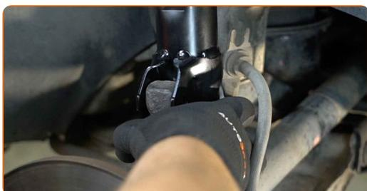
**35** Installez les boulons de fixation.
