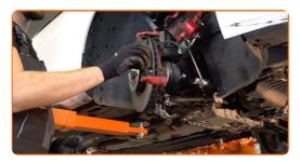
Remplacement : plaquettes de frein – VW Caddy III Break (2KB, 2KJ, 2CB, 2CJ). Les experts d'AUTODOC recommandent :
