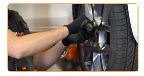
Abaissez la voiture et serrez les boulons de roue en ordre croisé. Utilisez une clé dynamométrique. Serrez-le jusqu'à 120 Nm.
