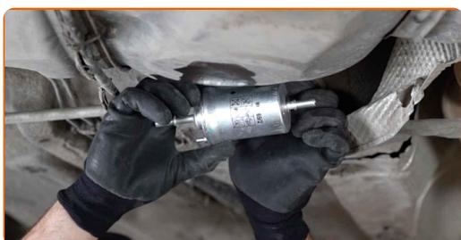
Remplacement : filtre à carburant – VW Caddy III Van (2KA, 2KH, 2CA, 2CH).
