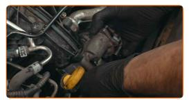
Serrez les fixations du boîtier papillon au collecteur d'admission d'air. Utilisez la mèche Torx T27. Utilisez une clé dynamométrique. Serrez-le jusqu'à 14 Nm.
