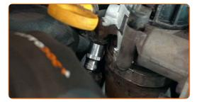
Desserrez la fixation du tuyau d'admission d'air. Utilisez une douille n° 7. Utilisez une clé à cliquet.
