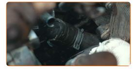
Attachez le collier de serrage au tuyau de refroidissement supérieur. Utilisez des pinces à bec long.
