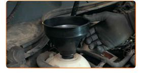
Versez du liquide de refroidissement dans le réservoir.
