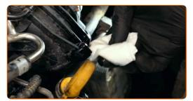
Installez la vanne d'étranglement du collecteur d'admission. Installez les boulons de fixation.
