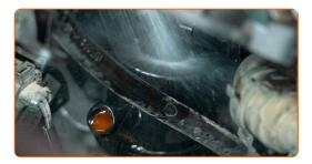
Dévissez les fixations du boîtier du thermostat. Utilisez une douille n° 10. Utilisez une clé à cliquet.
