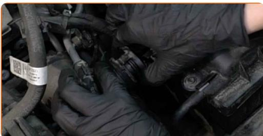
**4** Débranchez le tuyau à vide du boîtier du filtre à air.
