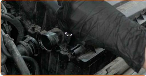
**14** Raccordez le tuyau à vide au boîtier du filtre à air.
