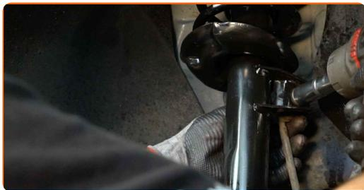
**8** Dévissez la fixation reliant la biellette à la barre stabilisatrice. Utilisez une clé mixte de No.18 Utilisez la clé HEX n° H5. Utilisez une clé à cliquet.
