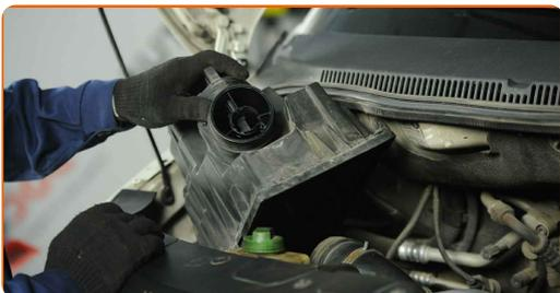
**64** Connectez le tuyau d'admission d'air au boîtier du filtre à air.
