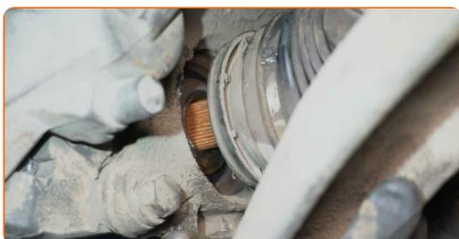
**77** Connectez le joint rotule à la fusée d'essieu.
