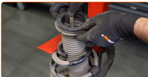
Remplacement : coupelle d'amortisseur – VW California T5 Minibus (7EC, 7EF, 7EG, 7HF). AUTODOC recommande :
