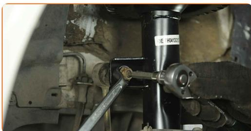
**84** Connectez l'extrémité du tirant à la fusée d'essieu.
