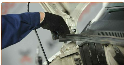
**36** Dévissez les boulons de fixation du couvercle de protection. Utilisez la mèche Torx T30. Utilisez une clé à cliquet.
