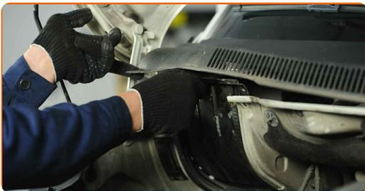
**60** Serrez les boulons de fixation du couvercle de protection. Utilisez la mèche Torx T30. Utilisez une clé à cliquet.
