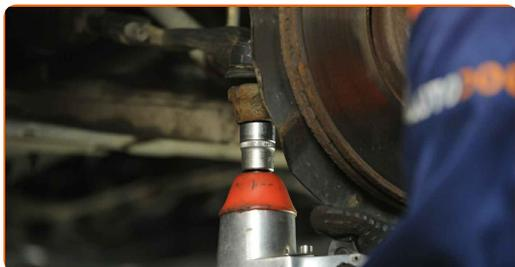
**86** Installez l'écrou de fixation.
