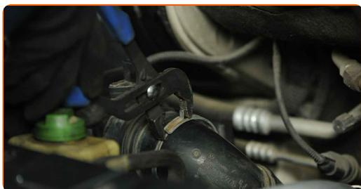
**32** Déconnectez le tuyau d'admission d'air du boîtier du filtre à air.
