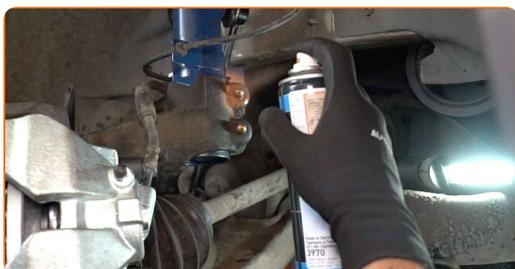
**89** Appliquez du produit sur la zone de contact entre le disque de frein et la jante. Utilisez du lubrifiant céramique.
