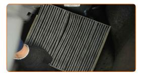
Remplacement : filtre d'habitacle – VW California T6 Minibus (SGC, SGG, SHC).
