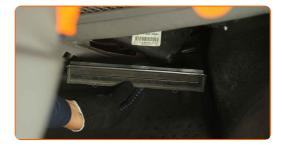
Vissez les attaches du couvercle du boîtier du filtre d'habitacle. Utilisez une douille n° 7. Utilisez une clé à cliquet.
