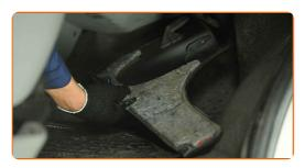
Vissez les fixations du panneau latéral sous planche de bord du côté passager. Utilisez la mèche Torx T20. Utilisez une clé à cliquet.
