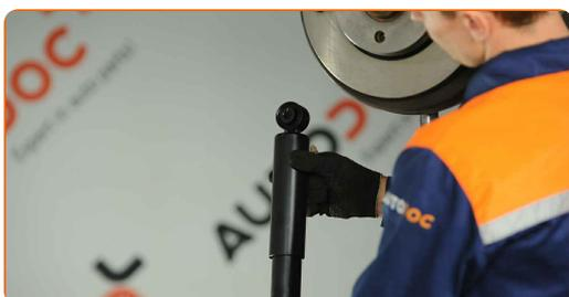
**15** Installez les boulons de fixation.
