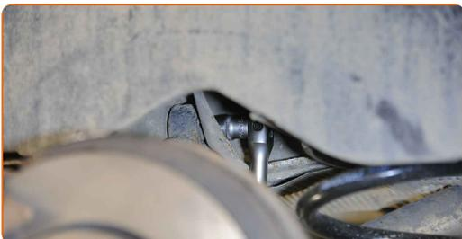
**11** Retirez l'écrou de fixation.
