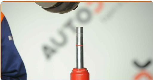
**9** Retirez l'écrou de fixation.
