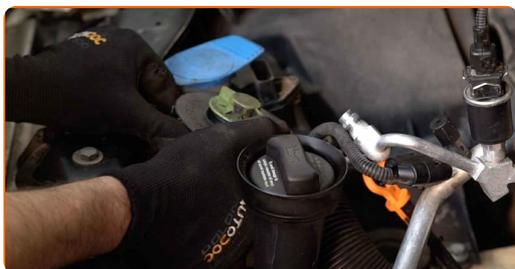
**7** Desserrez l'attache, et retirez le tuyau d'arrivée d'air du compartiment filtre. Servez-vous de pinces pour pompe à eau.
