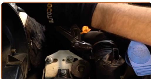
**8** Déverrouillez les clips du couvercle du filtre à air.
