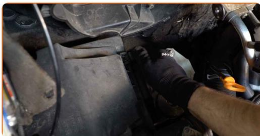
**9** Dévissez les boulons de fixation du compartiment du filtre. Utilisez la clé HEX n° H5.
