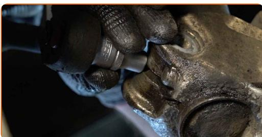
**28** Nettoyez les fixations assurant la connexion entre la jambe d'amortisseur et le porte-fusée. Utilisez une brosse métallique. Servez vous de l'aérosol WD-40.
