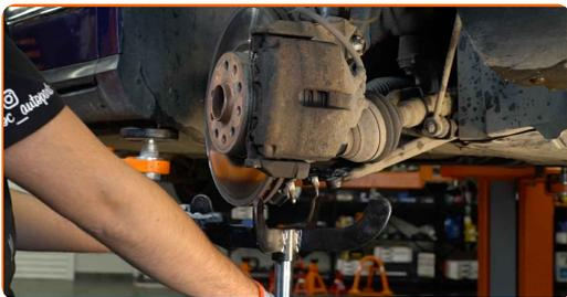
**26** Retirez l'écrou de fixation.
