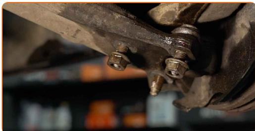
**59** Serrez l'attache du joint rotule. Utilisez une douille n° 16. Utilisez une clé dynamométrique. Serrez-le jusqu'à 60 Nm.
