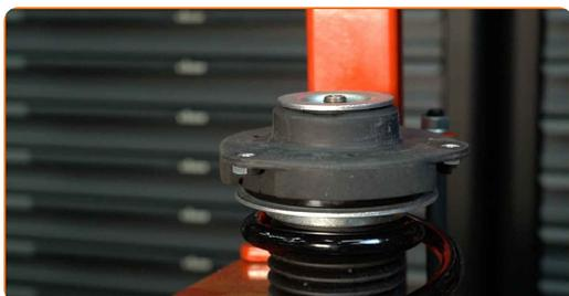
**44** Serrez l'écrou de l'entretoise d'amortisseur due la tige de piston. Utilisez une douille n° 19. Utilisez la clé HEX n° H6. Utilisez une clé dynamométrique. Serrez-le jusqu'à 60 Nm.
