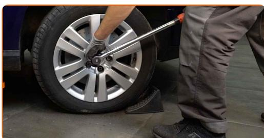
**77** Serrez le boulon reliant l'arbre de transmission au moyeu de roue. Servez-vous d'une douille 12 pans N°24. Utilisez une clé dynamométrique. Serrez-le jusqu'à 200 Nm.+180°
