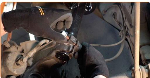
**54** Serrez les fixations inférieures qui relient l'amortisseur à la fusée d'essieu. Utilisez une douille n° 18. Servez vous de la douille XZN n°12. Utilisez une clé à cliquet.
