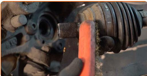
**57** Montez l'arbre de transmission sur le moyeu de roue.
