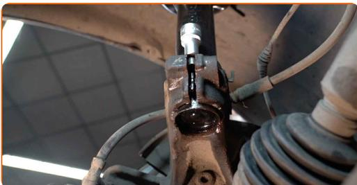
**53** Installez l'écrou de fixation.
