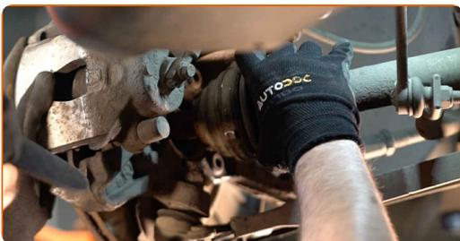
**58** Attachez le joint à rotule au bras de contrôle.
