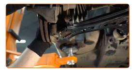
Vissez les fixations de la rotule. Utilisez une douille n° 13. Utilisez une clé à cliquet.
