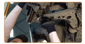
Retirez la fixation avant du bras de suspension. Utilisez une douille n° 18.
