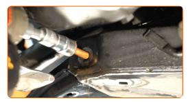
16 Attachez le joint à rotule au bras de contrôle.
