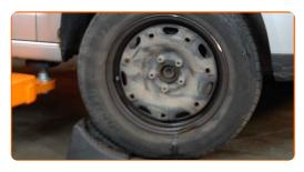
Desserrez les boulons de fixation de la roue. Servez-vous d'une douille à choc pour roue N°17.
