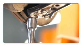
Serrez la fixation avant reliant le bras de commande au sous-châssis. Utilisez une douille n° 18. Utilisez une clé dynamométrique. Serrez-le jusqu'à 70 Nm.+90°
