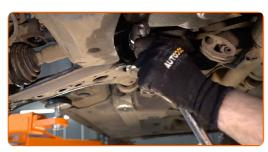
Dévissez les fixations qui lient le joint à rotule au bras de contrôle de suspension. Utilisez une douille n° 13. Utilisez un porte-taraud.
