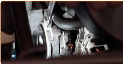
**15** Installez la courroie striée en V sur le tendeur.
