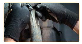
12.1 Nettoyez les fixations assurant la connexion entre la jambe d'amortisseur et le porte-fusée.
