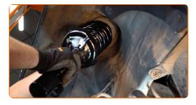
Vissez l'attache supérieure du support de l'amortisseur. Utilisez une douille n° 13. Ne serrez pas trop.
