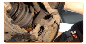
Vissez les fixations de la rotule. Utilisez une douille n° 13. Utilisez une clé à cliquet.
