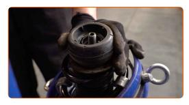
Serrez l'écrou de l'entretoise d'amortisseur due la tige de piston. Utilisez une douille n° 21. Utilisez la clé HEX n° H7. Utilisez une clé dynamométrique. Serrez-le jusqu'à 60 Nm.
