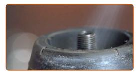
Retirez l'écrou de la tige de piston de l'entretoise. Utilisez une douille n° 21. Utilisez la clé HEX n° H7. Utilisez une clé à cliquet.
