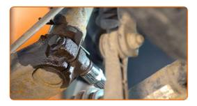
19 Retirez l'écrou de fixation.
