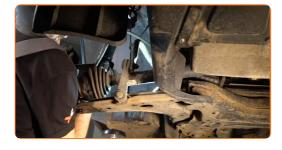
46 Installez l'écrou de fixation.
