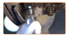
Dévissez les fixations qui lient l'arbre de transmission au moyeu de roue. Servez-vous d'une douille 12 pans n°30.
