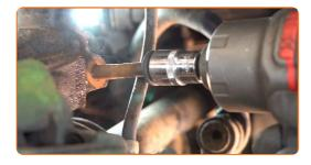
Relâchez la fixation inférieure assurant la connexion entre la jambe d'amortisseur et le porte-fusée. Servez-vous d'une douille spéciale pour retirer l'amortisseur.
