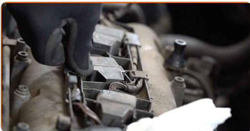
**20** Retirez le chiffon microfibre qui se trouve sur l'orifice de remplissage d'huile.
