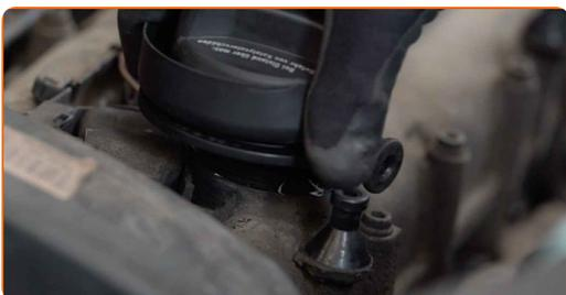
**22** Attachez le tuyau de ventilation du carter au goulot de remplissage d'huile.
