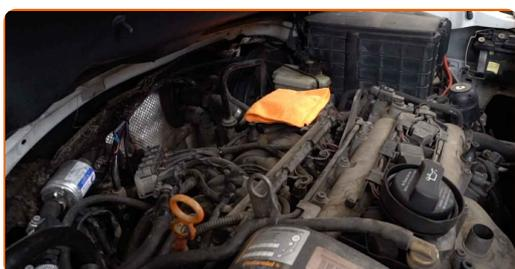
**6** Détachez le tuyau de ventilation du carter et le goulot de remplissage d'huile.
