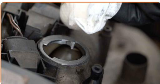
**21** Installez le goulot de remplissage d'huile. Vissez le goulot de remplissage d'huile.
