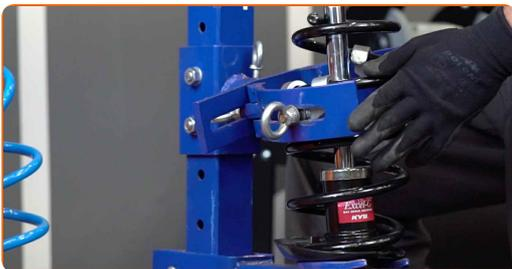
39 Installez la coupelle, le manchon et la butée de suspension sur l'amortisseur.
