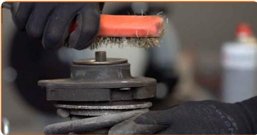
33 Retirez l'écrou de la tige de piston de l'entretoise. Utilisez une douille n° 21. Utilisez la clé HEX n° H6. Utilisez une clé à cliquet.
