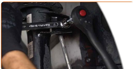
**18** Dévissez les fixations qui lient l'arbre de transmission au moyeu de roue. Servez-vous d'une douille 12 pans N°24.
