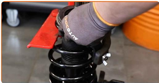
**49** Installez la jambe de suspension supérieure en même temps que la butée.
