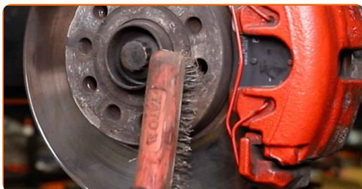
**80** Appliquez du produit sur la zone de contact entre le disque de frein et la jante. Utilisez du lubrifiant céramique.
