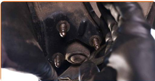
**68** Serrez les fixations qui relient le joint à rotule au bras de suspension. Utilisez une douille n° 16. Utilisez une clé à cliquet.
