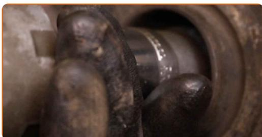
**67** Attachez le joint à rotule au bras de contrôle.
