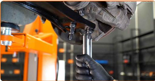
18 Vissez l'attache du bras avant. Utilisez une douille d'entraînement n°18 ou une clé polygonale n°18. Serrez-le jusqu'à 70 Nm.+90°
